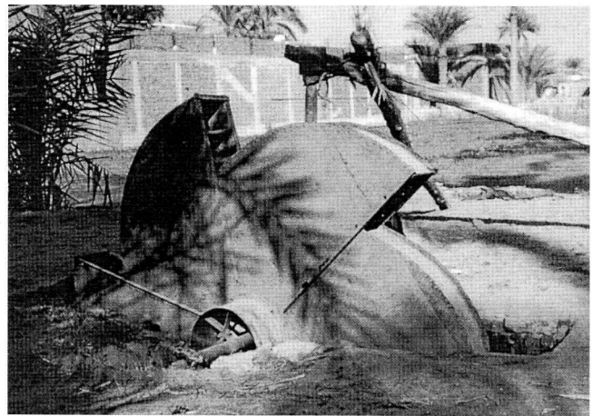
Fig. 1. Malba égyptienne: appareil à tambour comprenant six compartiments spiralés, de section carrée conduisant l'eau vers l'axe de la roue; ce type de machine est attesté à Bagdad au 12 e siècle.
