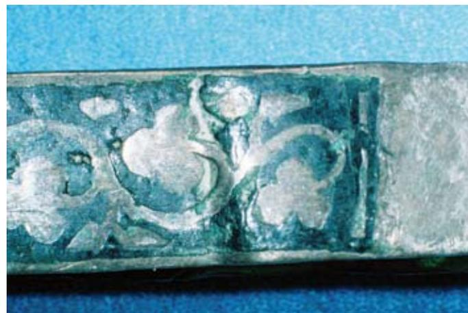
Abb. 8 Riemenschlaufe Inv.-Nr. 2023/80: Lichtmikroskopisches Detail der Nielloeinlagen
